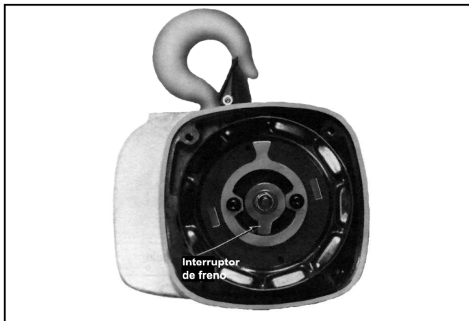
Figura 7-6. Posición del interruptor de freno para modelos de 1/4 y 1/2 tonelada
