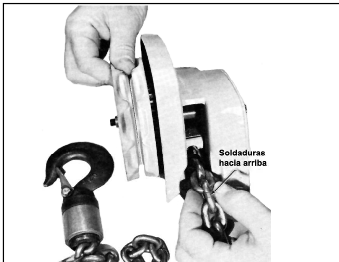
Figura 7-8. Instalación de la cadena de carga
